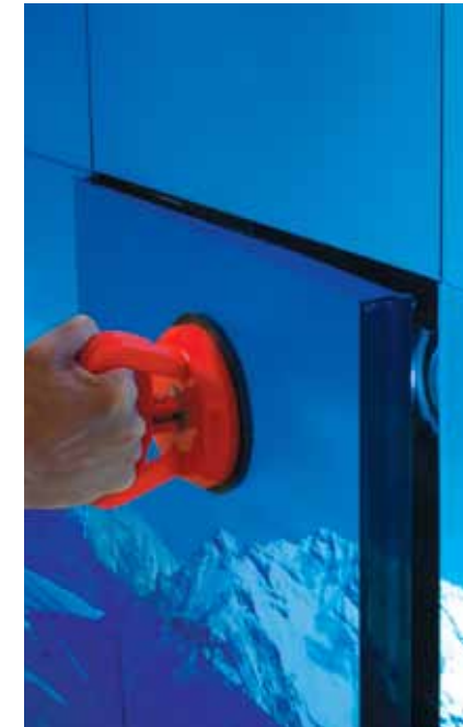
Ein handlicher Saugnapf ermöglicht einfachen Zugang zu jedem Tile des Displays
